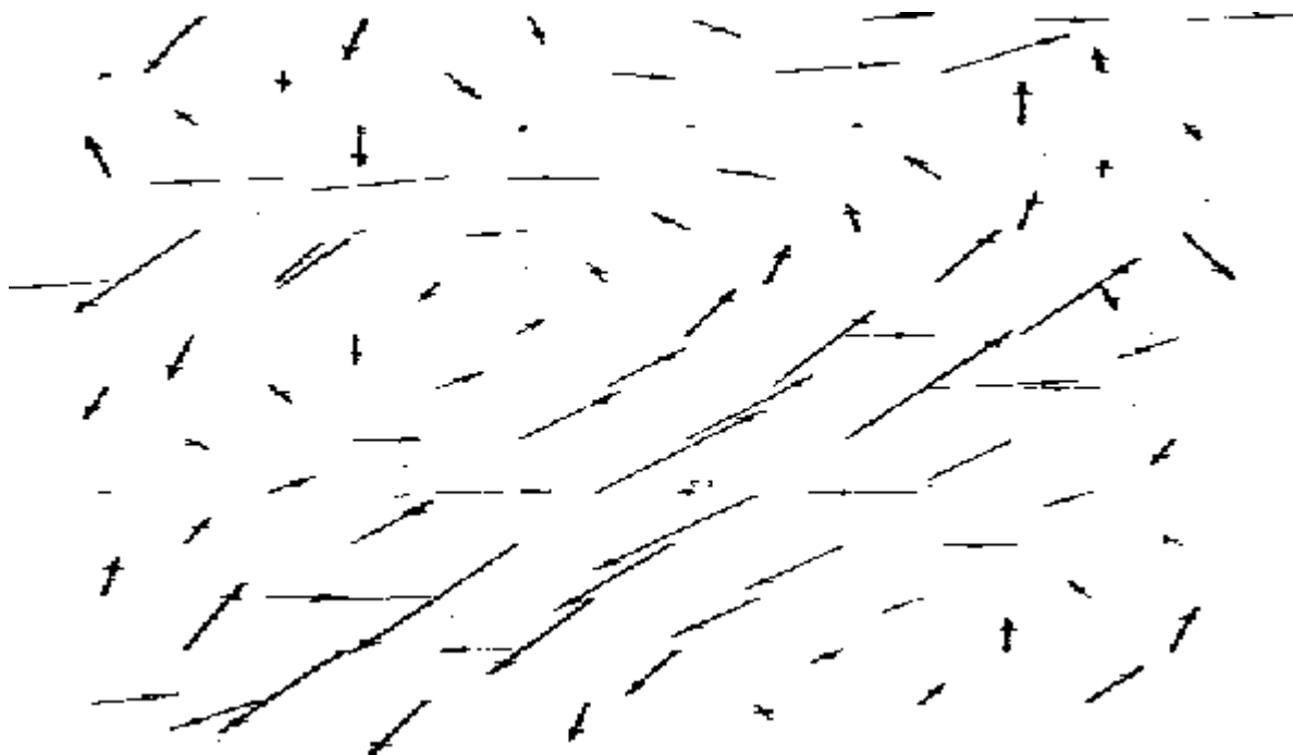
Рис. 2.5 Схема смещений частиц при релаксации напряжений. Смещения увеличены в три раза
