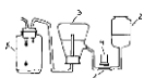
Рис.3.2а) Схема установки для изучения “застудневания” жидкости в капилляре: 1 - капилляр; 2, 3 -сообщающиеся сосуды; 4 микроскоп для наблюдения течения; 5 - капельница
