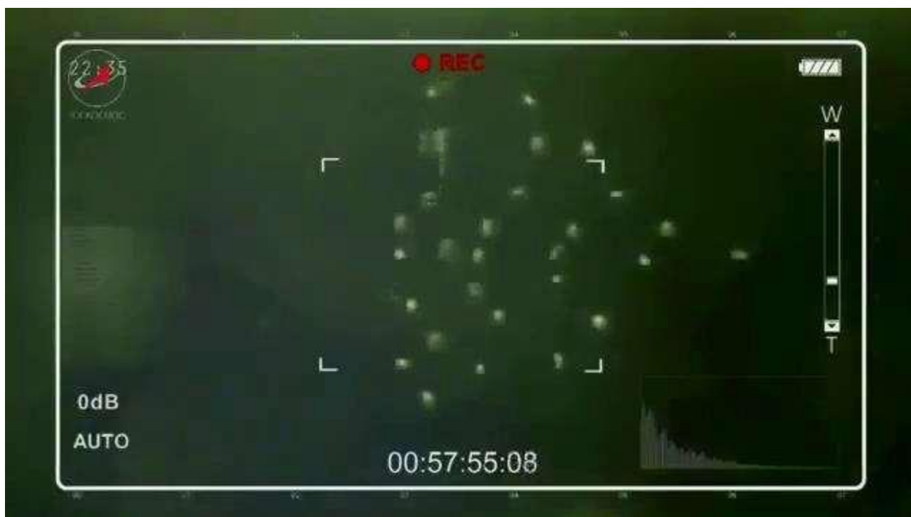
Рис. 3.17. Двухкомпонентный пылевой кристалл. На видеоролике [195] видны колебания «кристаллической пылевой решетки» примеси (светлые частицы) относительно решетки основного компонента (темные частицы)
