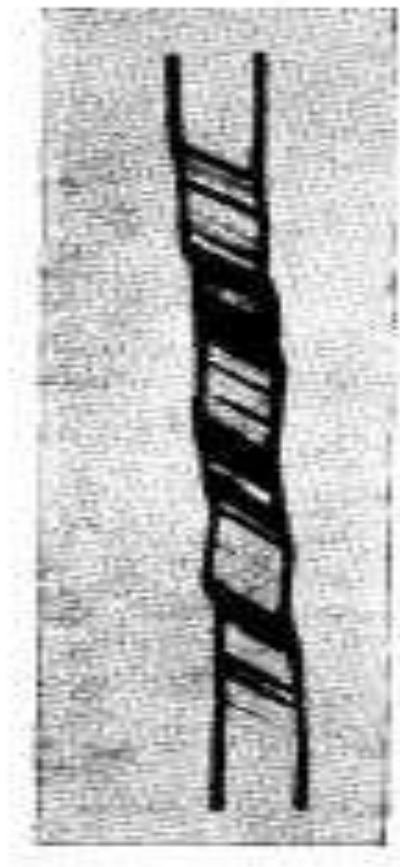
Рис. 4.10. Малый монокристалл меди после растяжения [12]. Видны параллельные полосы плоскостей скольжения, разбивающие монокристалл на блоки
